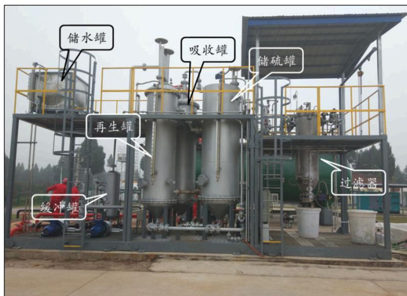
图 3.1-11 闪蒸气脱硫装置案例照片
