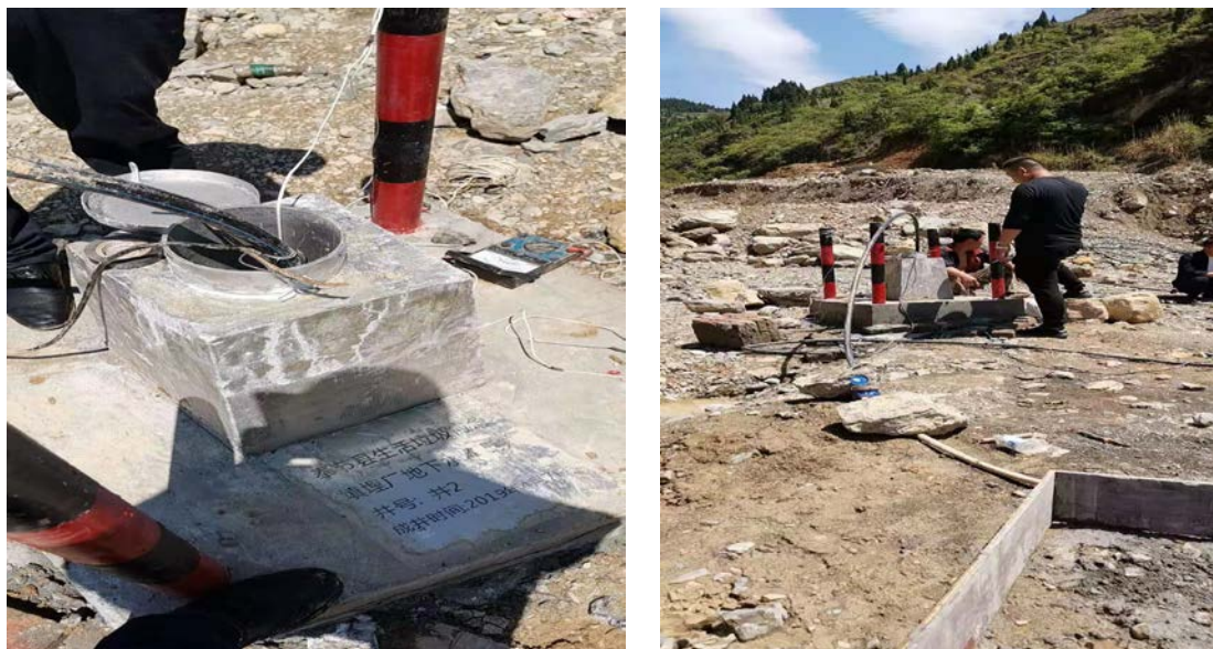
图 4.3-1 钻孔抽水试验图
