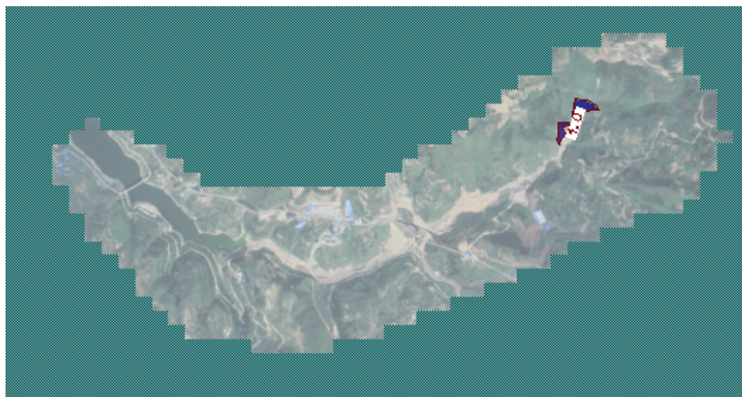
图 5.2-13 \text{BOD}_5 污染晕 100 天污染迁移分布图
