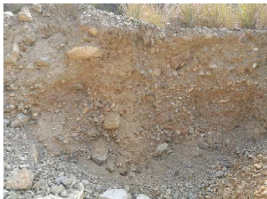
图 4.1-13 第四系冲洪积物块石土
