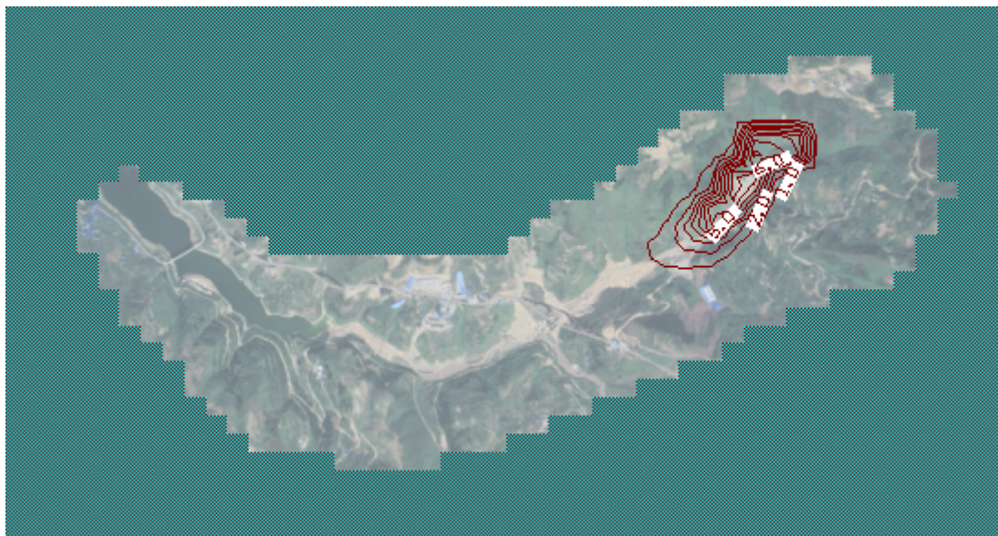
图 5.2-10 COD Cr 污染晕 100 天污染迁移分布图
