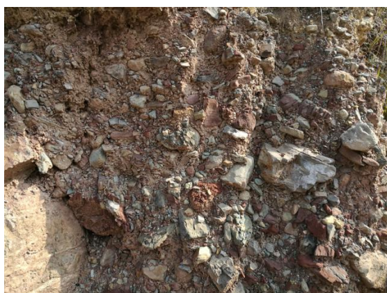
图 4.1-15 第四系冲洪积层（碎块石土） 图 4.1-16 第四系残坡积（粉质粘土）
