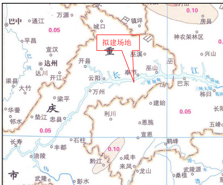
图 4.1-8 地震加速度等值线图
