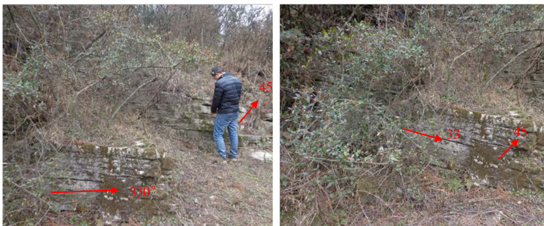
图 4.1-7 场地内基岩发育的裂隙面
